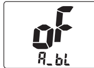
Automatische Beleuchtung AUS
